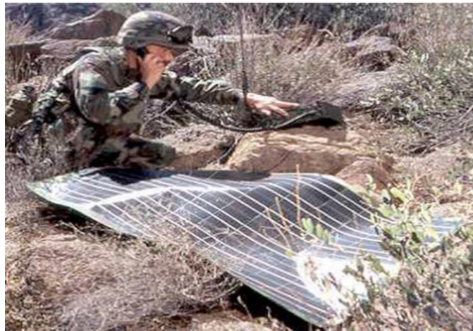
ภาพที่ 1 การใช้แผงเซลล์แสงอาทิตย์แบบฟิล์มบาง กับระบบการสื่อสารในพื้นที่ห่างไกล (Kodigala, 2014)
